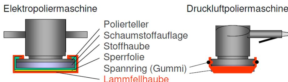
Ca. 2 ml bis 5 ml **NewPro permaSeal@CARE 150** auf die Mitte des Poliertellers auftragen und mit der angeschalteten Poliermaschine ohne zusätzlichen Druck auf ca. 0,5 – 1 m<sup>2</sup> Lackoberfläche verarbeiten. Dabei die Poliermaschine unter kreisförmigen Bewegungen mehrmals über die benetzte Fläche bewegen, um ein gleichmäßiges Auftragen und langsames Ablüften der Versiegelung zu erreichen.
